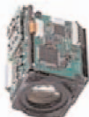
Электронно- оптическая (EO) камера с 10-кратным увеличением
